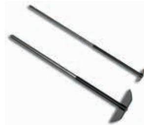
Pá padrão (inferior) com minipá não compendial
